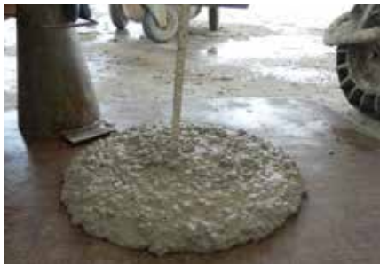
Specifikace a výroba betonu Dle Normy ČSN EN 206-1 nelze specifikovat parametry, které by měl beton pro bílé vany splňovat. Vlastnosti vyráběného betonu jsou průběžně kontrolovány, před dopravením na stavbu probíhá ještě kontrola kvality betonu včetně odběru vzorků na kontrolní testy.
