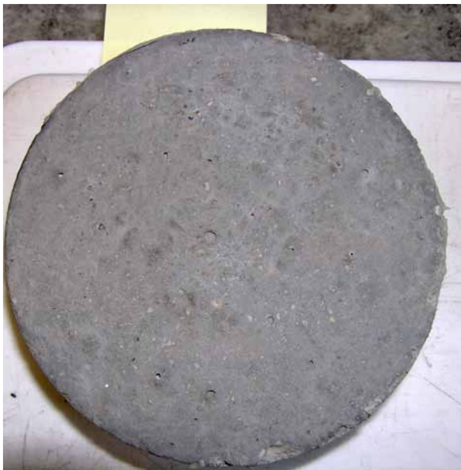
Obr. 3: Povrch zkušebního tělesa po zkoušce odolnosti vůči vodě a CHRL metodou C – naměřený odpad 33,1 g/m 2 (těleso vyrobeno bez úpravy povrchu)
