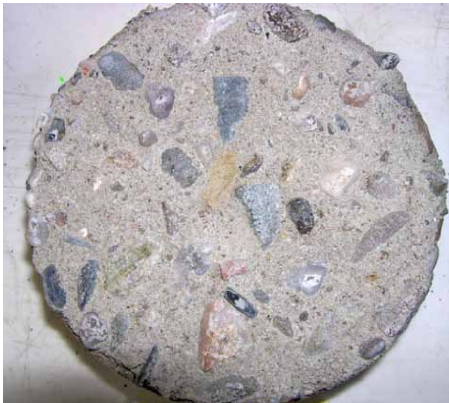
Obr. 2: Povrch zkušebního tělesa po zkoušce odolnosti vůči vodě a CHRL metodou C – naměřený odpad 6887 g/m 2
