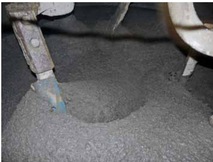
Obr. 3: Pohled do míchacího jádra při výrobě UHPC
