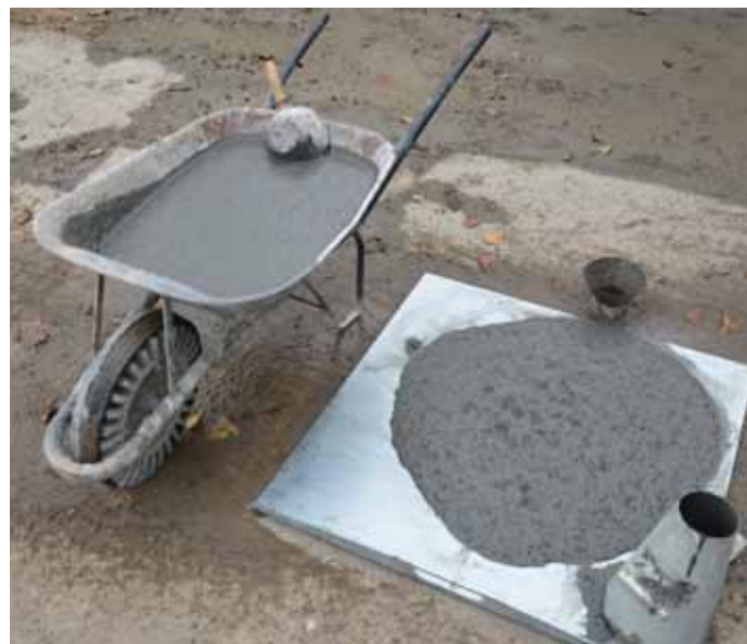
Kontrola konzistence a odběr vzorku betonu pro zkoušení
