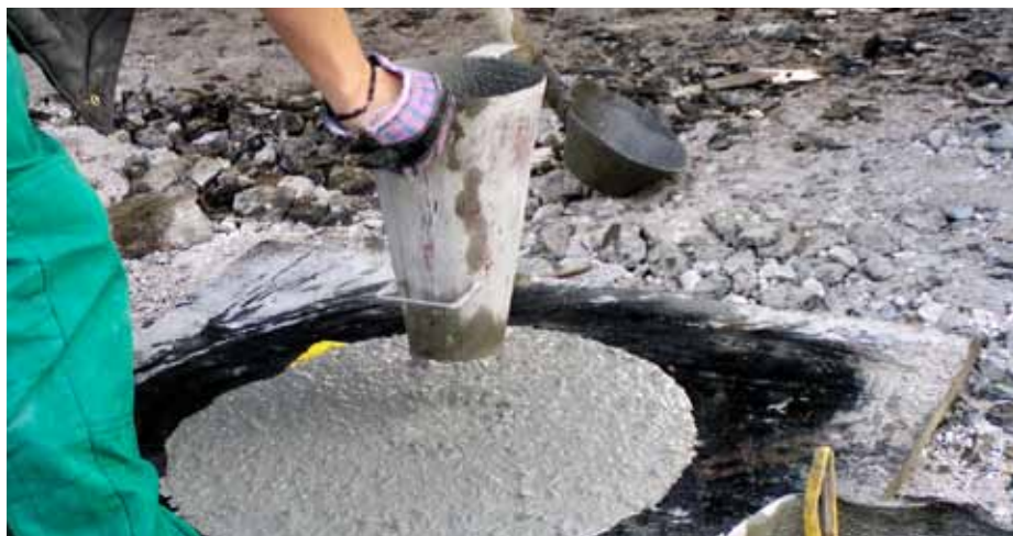
Obr. 4: Zkouška rozlivu SCC pro most přes Seifertovu ulici
